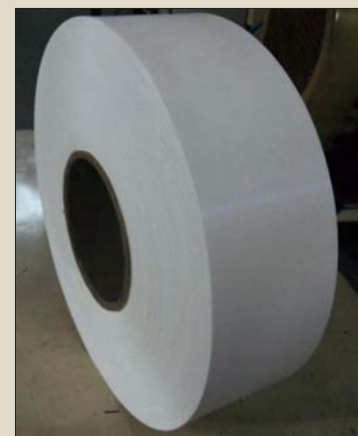
Fig. 2 – “Jumbo” no ponto de ser recortado e transformado em fitas
