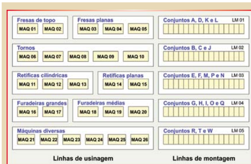
Fig. 3 – Estrutura sintetizada de linhas de usinagem de montagem de barras de direção
