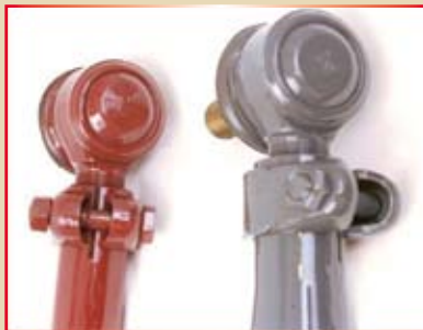
Fig. 4 – Vista parcial das barras de direção com seus diâmetros reduzidos
